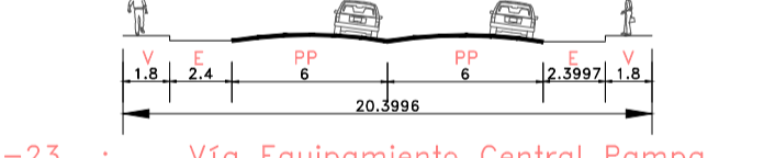
Sección 23-23 : Vía Equipamiento Central Pampa
